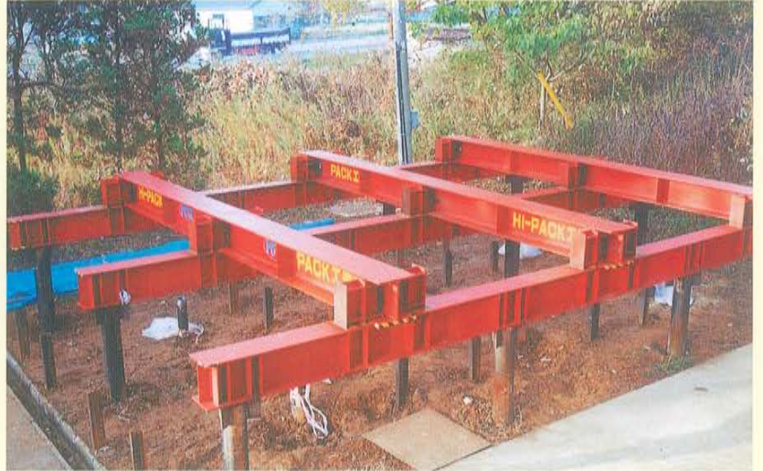
歪ゲージ装着試験杭 (NPパック・ハイパック)
