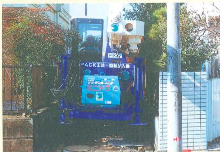
狭小現場への杭搬入専用台車（幅90cm）
