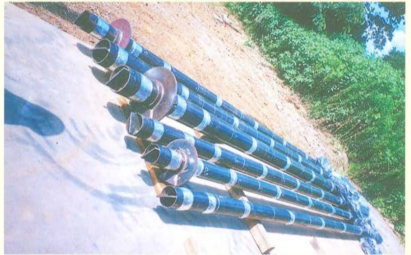
歪ゲージ装着試験杭 (NPパック・ハイパック)
