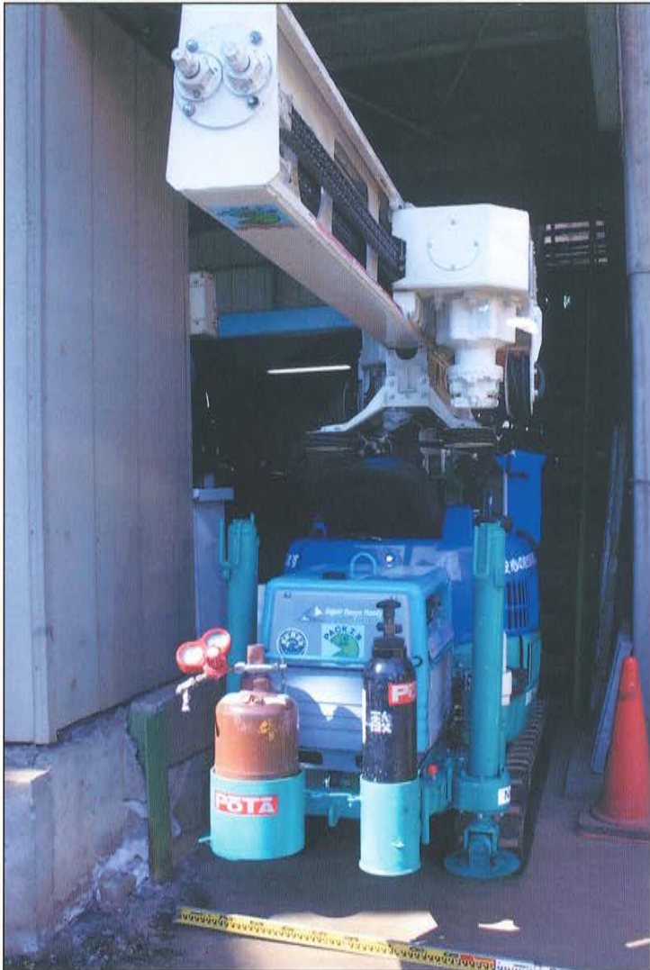
機体寸法 幅1.00m 長さ4.72m 高さ2.24m
