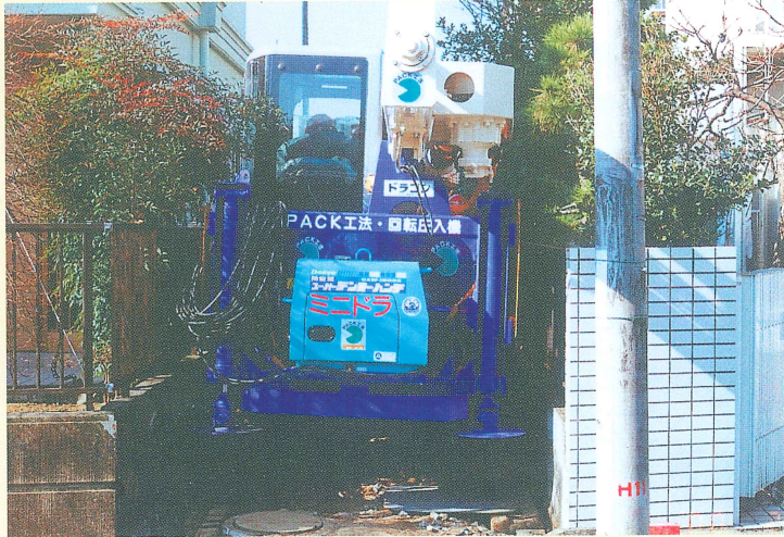
狭小現場への杭搬入専用台車（幅90cm）
