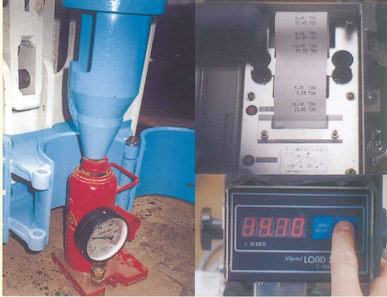
圧入力測定検査
