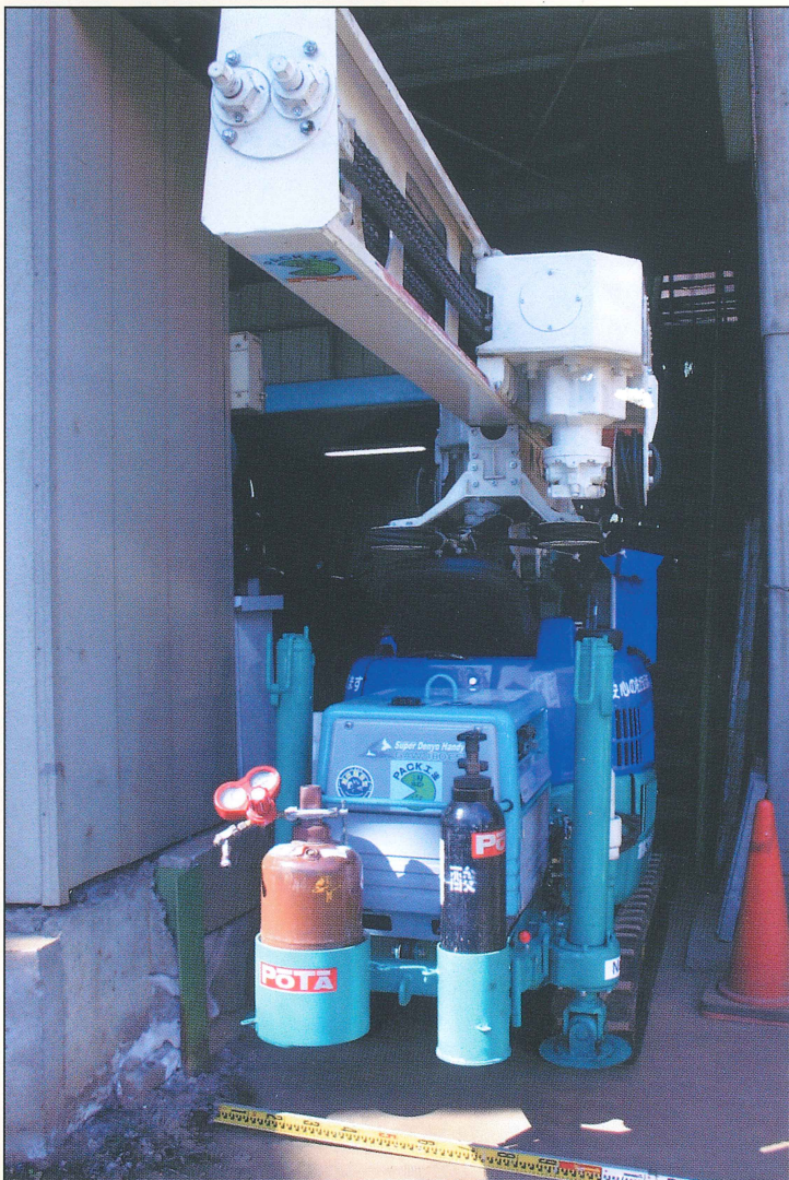
機体寸法 幅1.00m 長さ4.72m 高さ2.24m
